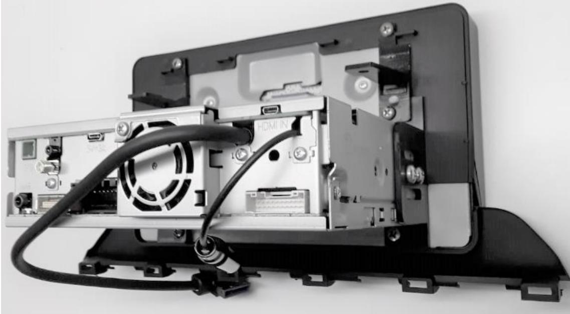
**Passo 3:** Efetuar todas conexões. Instalar no painel a moldura com a tela, fixar com parafusos do carro o suporte de fixação Moldura/Painel.
