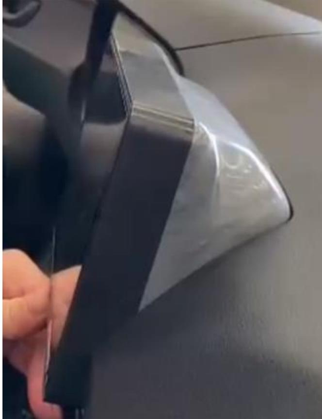
**Passo 5:** Instalar dutos de ar e moldura de acabamento.
