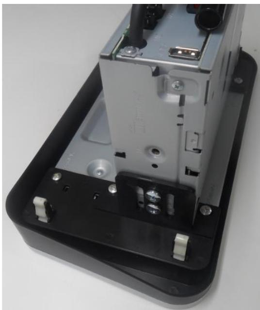
**Passo 7.** Efetuar as conexões, encaixar a moldura no suporte.
