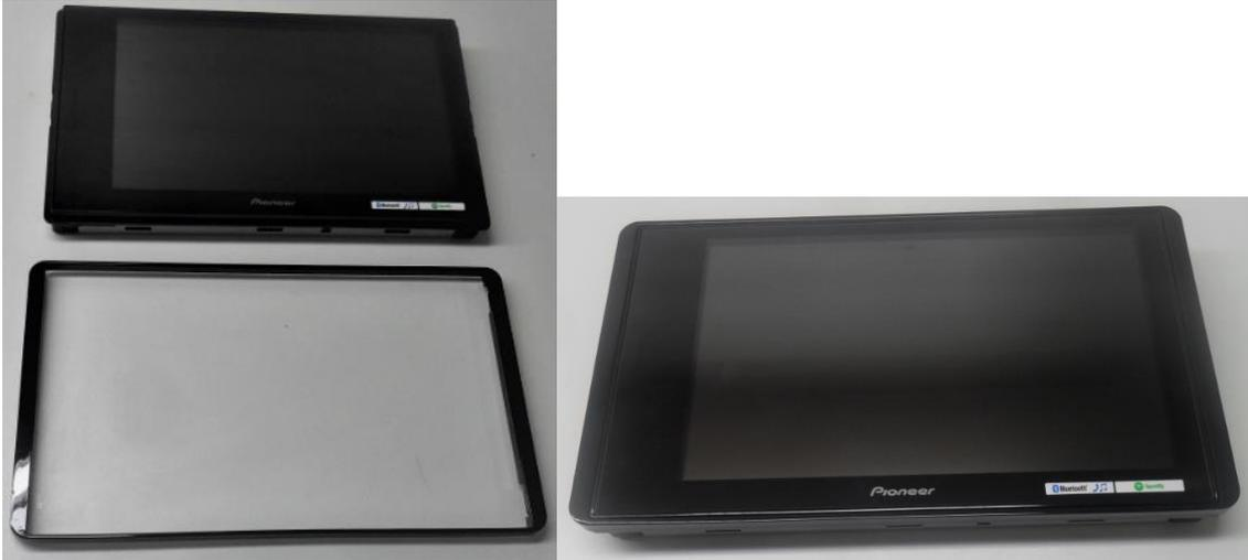
**Passo 5.** Encaixar o aparelho na moldura, virar para fixar a tela e suportes, usando os parafusos que acompanham o aparelho.
