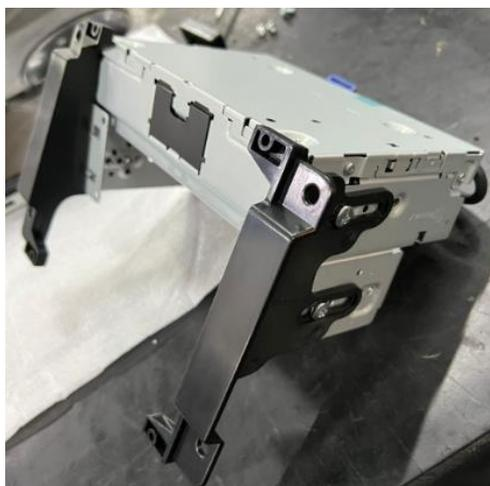
**Passo 2:** Conectar os cabos, inserir no painel do carro, fixar com 4 parafusos autofixantes.
