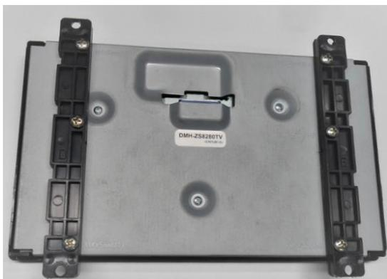
**Passo 4:** Conectar os cabos, colocar a tela, alinhando os suportes, fixar a parte superior e inferior com os parafusos autofixantes.
